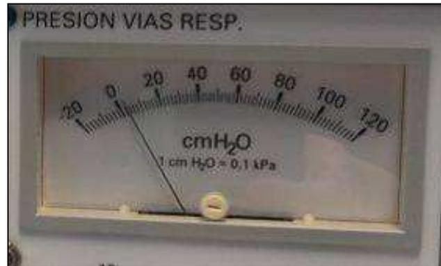
Figura 4.20. Manómetro del servo 900 C.
