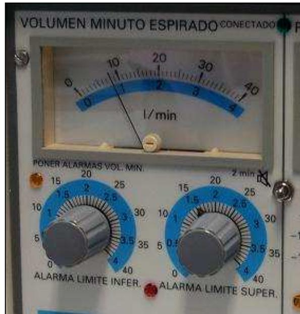
Figura 4.16. Espirómetro del servo 900 C.
