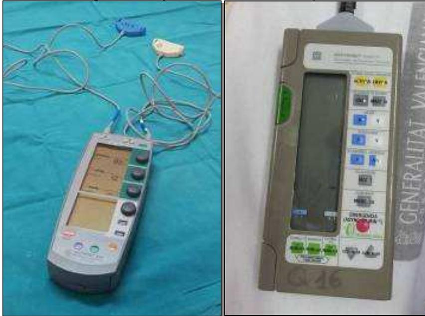
✓ **INTERRUPTOR DE PUESTA EN MARCHA/APAGADO.** Pone en marcha el generador; para apagarlo, es necesario pulsar varios botones simultáneamente para evitar apagarlo accidentalmente.
