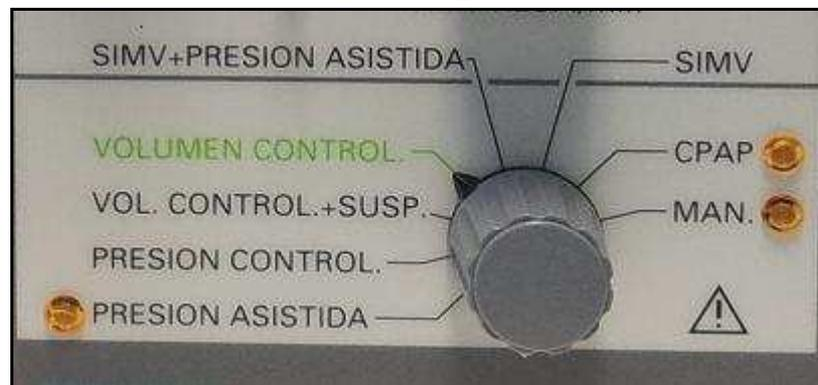
**Figura 4.25. Selector del modo de ventilación.**
